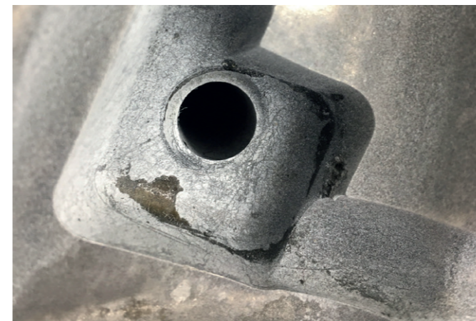
Fotographie des gesamten Auswerferbereichs einer gebrauchten Aluminiumdruckgussform © SLV Halle GmbH
