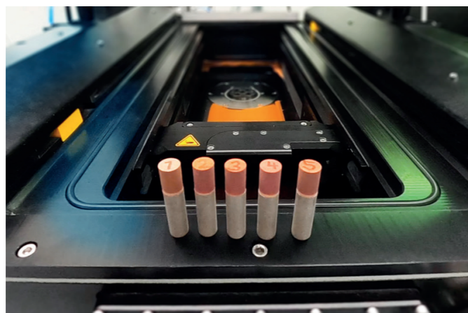
Pulverbett-gefertigte Stahl-Kupfer-Proben © SLV Halle GmbH
