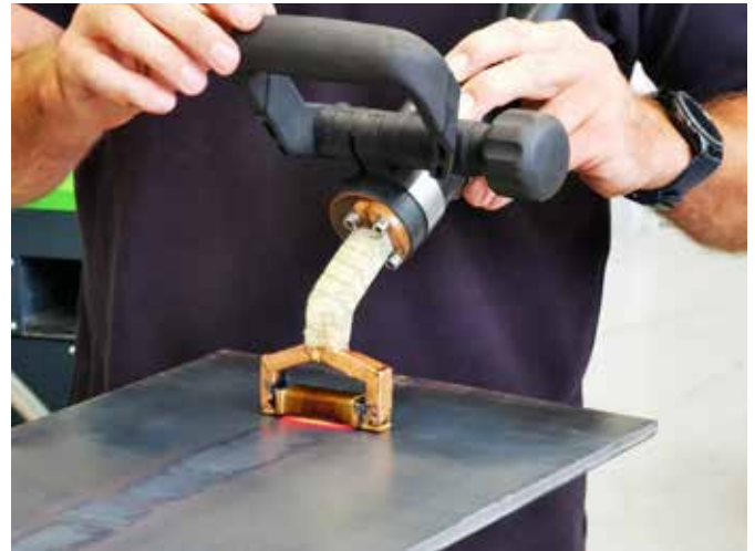
Abb. 2: Induktives Richten eines geschweißten Doppel-T-Trägers (Bild: SLV Halle GmbH)
