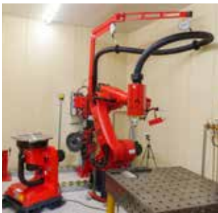
Abb. 2: Laseranlage der Firma ALOtec Dresden GmbH zum Laserauftragschweißen mit dem ProFocus-Bearbeitungskopf der OSCAR PLT GmbH (Bild: SLV Halle GmbH)
