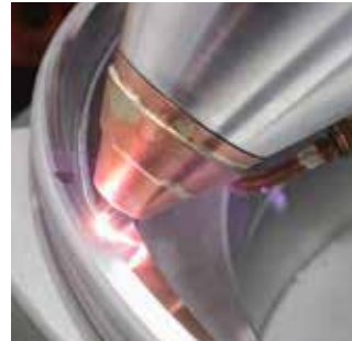
Abb. 4: Laserbearbeitungskopf ProFocus von OSCAR PLT GmbH im Einsatz (Bild: SLV Halle GmbH)
