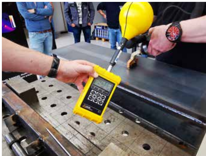
Abb. 1: Messung der magnetischen Feldstärke beim induktiven Richten (Bild: SLV Halle GmbH)
