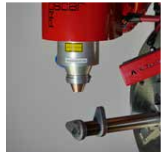
Abb. 5: mittels LDM erzeugte Nockenwelle aus dem Werkstoff 1.4301 (Bild: SLV Halle GmbH)
