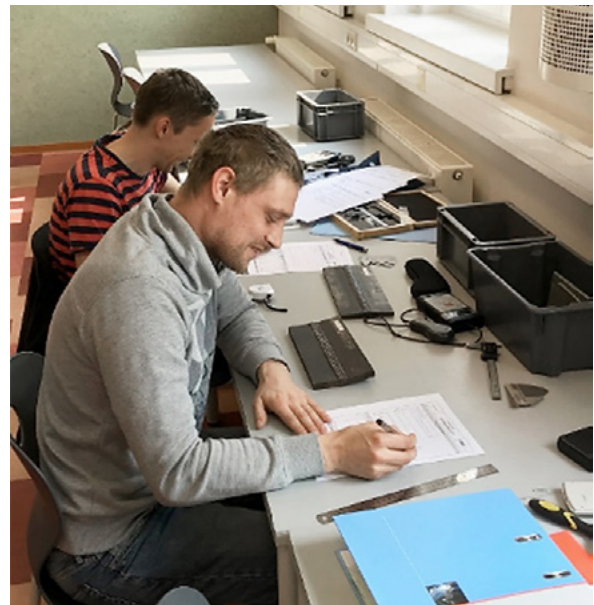
Zwei angehende Prüfwerker tragen an einer Stumpfnahrt gefundene Unregelmäßigkeiten in ihr Protokoll ein.
