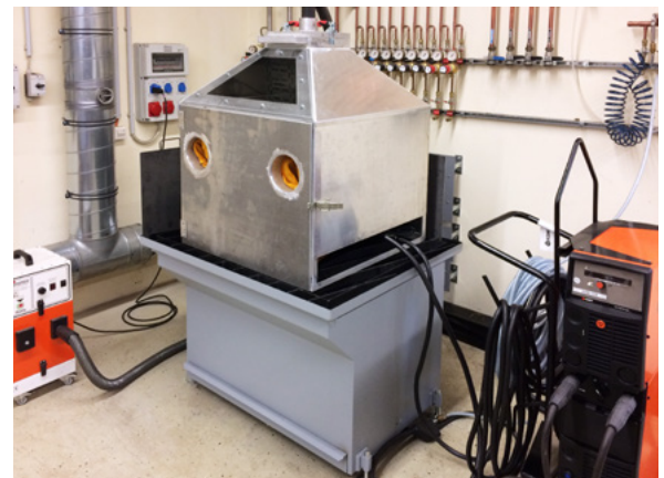
Versuchsstand mit Fume-Box zur Schweißraucherfassung.
