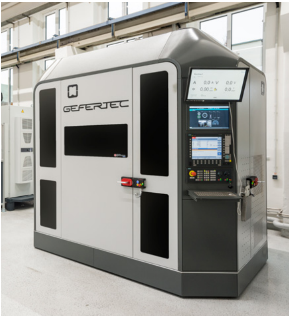
Neue Anlage zur Generierung metallischer Großstrukturen.
