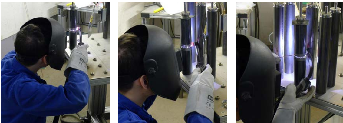
Schulung im Spiegelschweißen bei zunehmend eingeschränkter Zugänglichkeit
